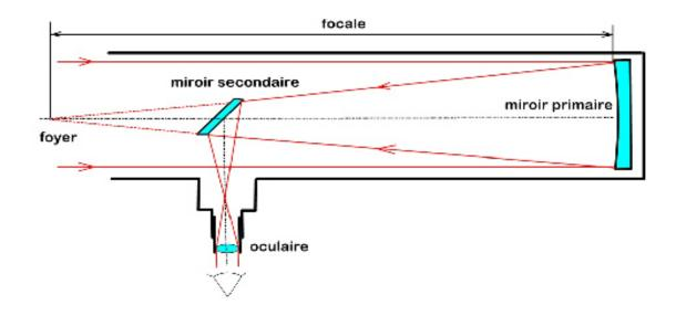
Schéma illustrant le principe du télescope de Newton
